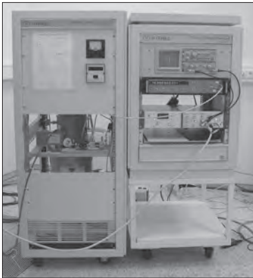
Obr. 8: Fotografie kvantového etalonu stejnosměrného napětí ČMI. V levé části je vakuová nádoba s chladicím zařízením a Josephsonovým čipem, v pravé části je osciloskop s voltampérovou charakteristikou Josephsonova čipu pro jeden kvantový stav, čítač a řídicí zdroj.
