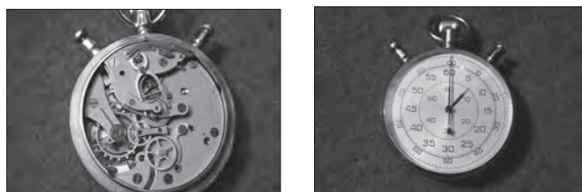
Obr. 1: Mechanické stopky a jejich vnitřní konstrukce
